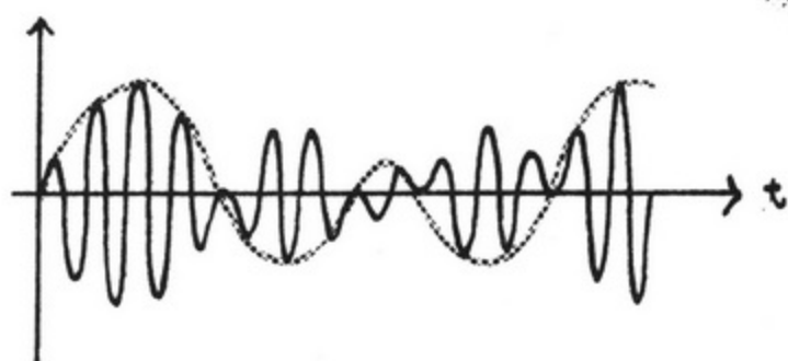
(c) AM 调制波 (电波原有的波形)
